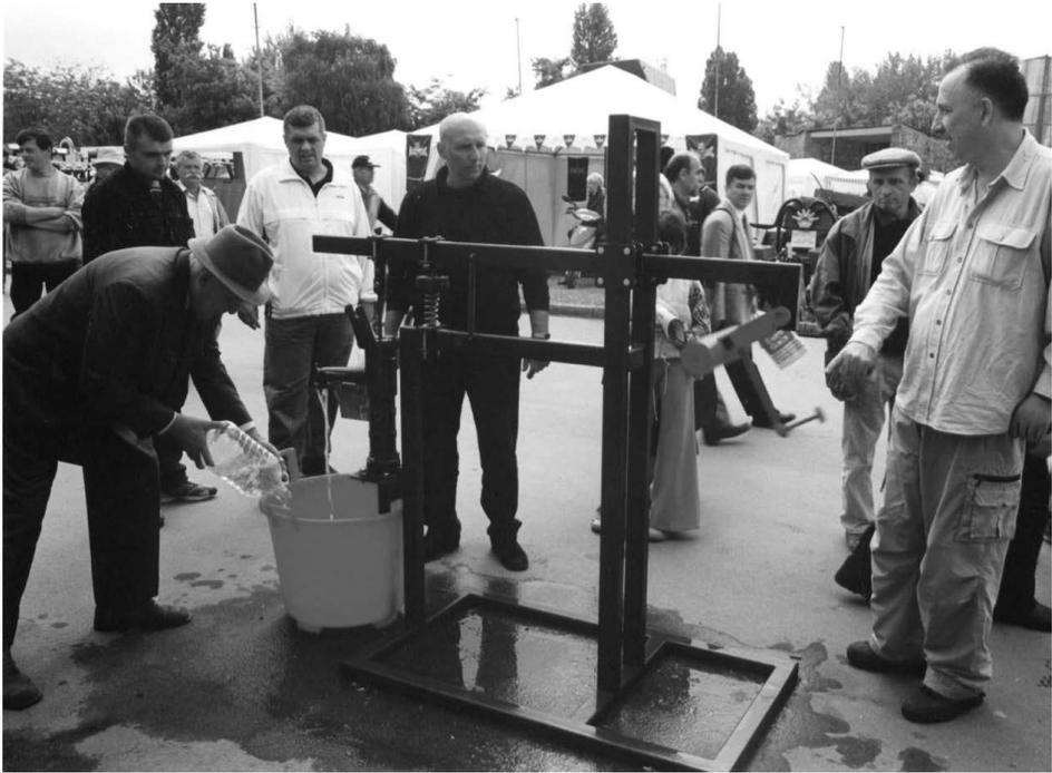
Abb. 141: Mit Pendel angetriebene Wasserpumpe (Quelle: Website VeljkoMilkovic.com)
