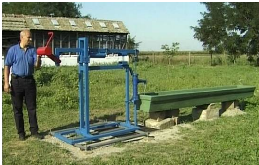
Ručna pumpa za vodu sa klatnom na terenu (okolina Novog Sada, avgust 2004.) http://youtu.be/hNpgI7o_1QI
