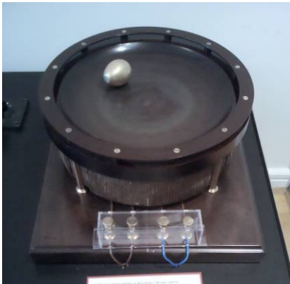
Slika 3. Teslin eksperiment „Kolumbovo jaje“ (indukcioni motor sa rotorom u obliku jajeta koje rotira u magnetnom polju) Muzej Nikole Tesle, Beograd
