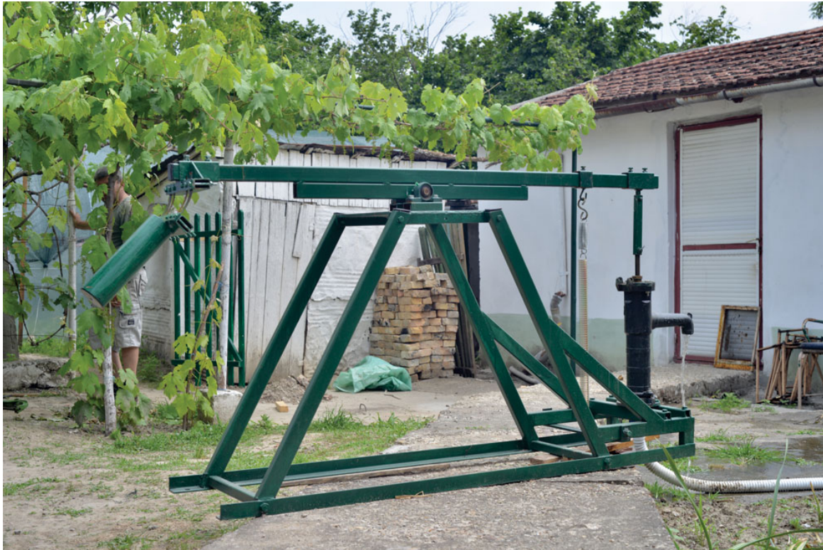
Slika 7. Pumpa za vodu sa elastičnim klatnom u pokretu.
