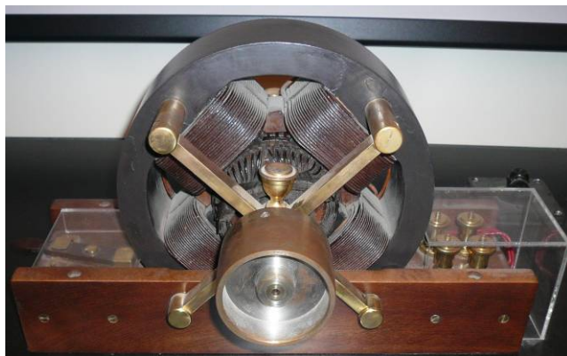
Slika 4. Kopija Teslinog indukcionog motora iz 1887. Muzej Nikole Tesle, Beograd
