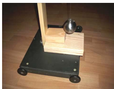
Slika 14. Elastično klatno na kolicima D=121 mm (maksimalna amplituda)
