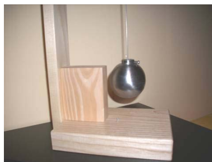
Slika 7. Elastično klatno D=43,2 mm (minimalna amplituda)
