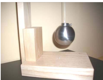
Slika 8. Elastično klatno D=85 mm (srednja amplituda)
