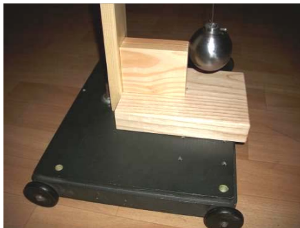
Slika 11. Elastično klatno na kolicima D=32,2 mm (blokirano klatno)
