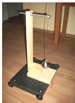
Slika 14. Elastično klatno na kolicima D=121 mm (maksimalna amplituda)
