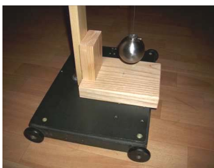
Slika 13. Elastično klatno na kolicima D=85 mm (srednja amplituda)
