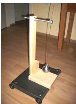
Slika 13. Elastično klatno na kolicima D=85 mm (srednja amplituda)
