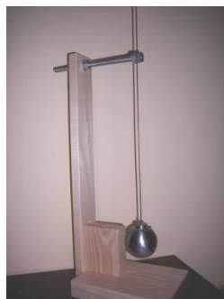
Slika 7. Elastično klatno D=43,2 mm (minimalna amplituda)
