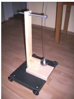
Slika 11. Elastično klatno na kolicima D=32,2 mm (blokirano klatno)
