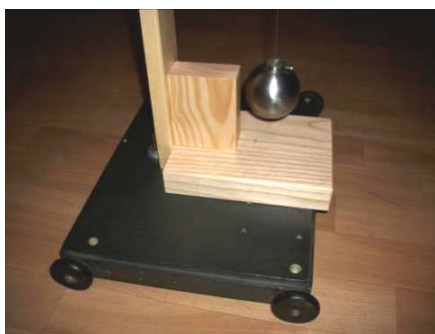
Slika 12. Elastično klatno na kolicima D=43,2 mm (minimalna amplituda)
