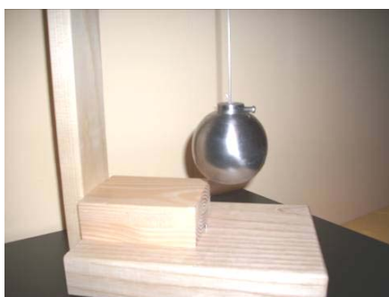
Slika 9. Elastično klatno D=121 mm (maksimalna amplituda)
