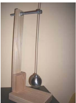
Slika 8. Elastično klatno D=85 mm (srednja amplituda)
