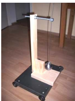
Slika 12. Elastično klatno na kolicima D=43,2 mm (minimalna amplituda)
