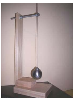
Slika 9. Elastično klatno D=121 mm (maksimalna amplituda)
