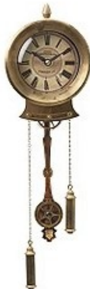
Slika 2. Zidni časovnik sa regulacionim klatnom i dva pogonska teža, od kojih jedan pogoni sat, a drugi otkucava sate.
