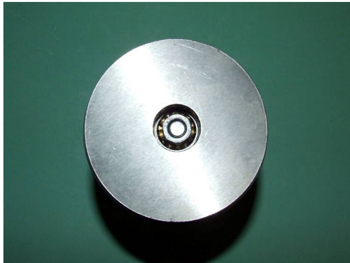
Slika 1. Gvozdeni disk – zamajac sa kugličnim ležajem
